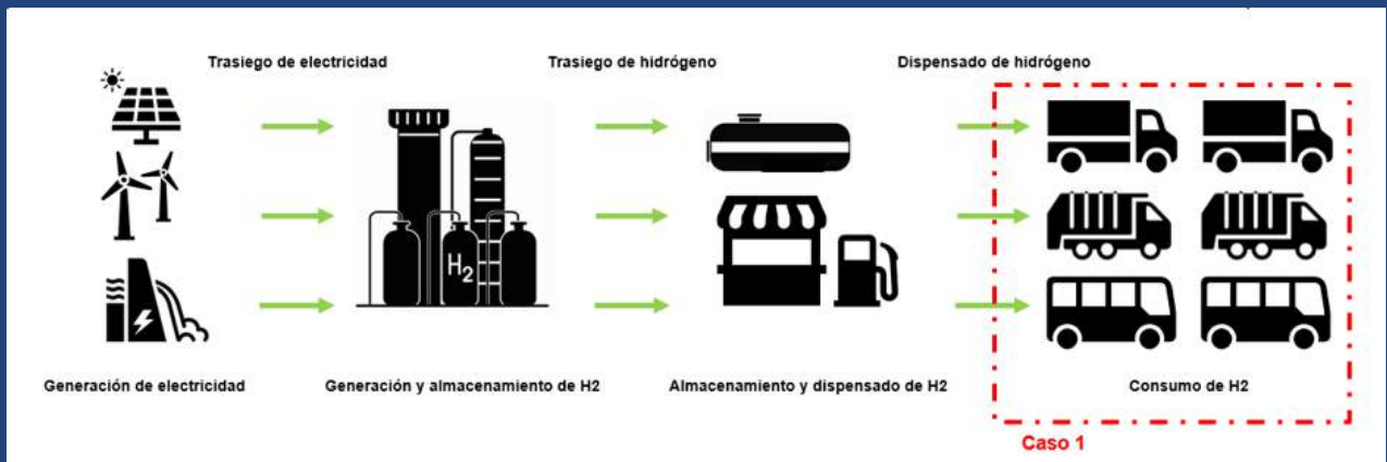
Figura 26: Esquemático general de cadena de suministro para producción de hidrógeno por electrólisis y dispensado para el transporte.
